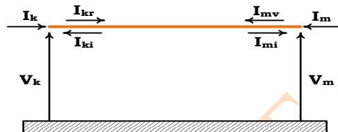
شکل ۳- دیاگرام ولتاژها و جریان‌ها در یک خط انتقال در مدل خط وابسته به فرکانس فاز.
