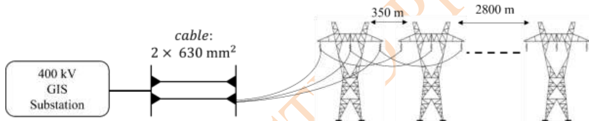
شکل ۲- شبکه قدرت متشکل از خط هوایی، کابل و پست گازی (GIS)، مطالعه اثر کلیدزنی پست GIS.
