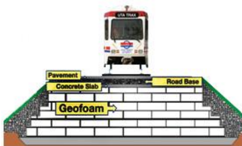
شکل ۵- خاکریز راه آهن ساخته شده با بلوک های ژئوفوم
