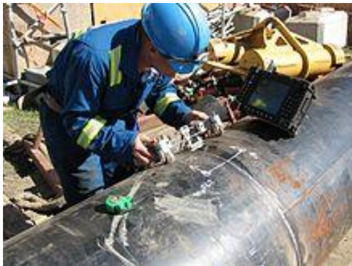
شکل ۱- بازرسی خط لوله به کمک روش آرایه فازی.
