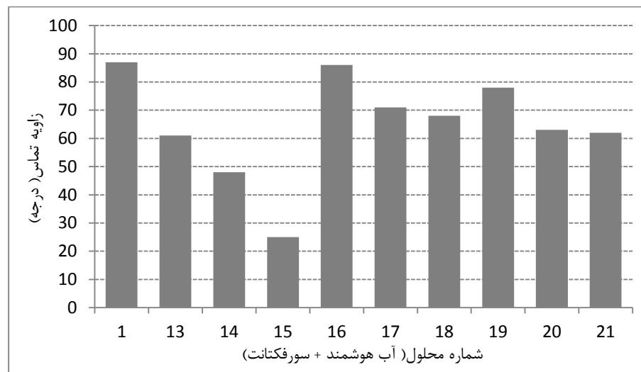
شکل ۶- مقادیر زاویه تماس قطره نفت بر روی سنگ کربناته برای محلول های آب هوشمند و سورفکتانت با غلظت متفاوت سورفکتانت (سیالات ۲۱-۱۳)
