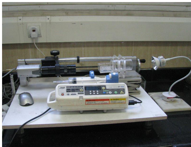
شکل ۲- دستگاه اندازه گیری زاویه تماس
