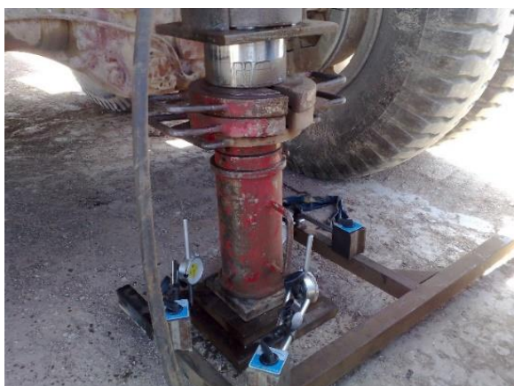
شکل ۳. آزمایش بارگذاری صفحه در مسیر خاکریز راه آهن قم- اصفهان
