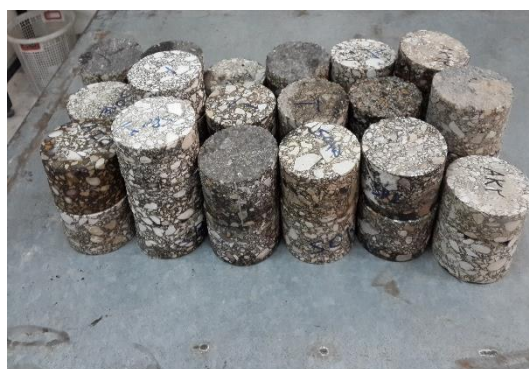
شکل ۳. نمونه‌های تهیه شده از برش مغزه‌های گرفته شده
