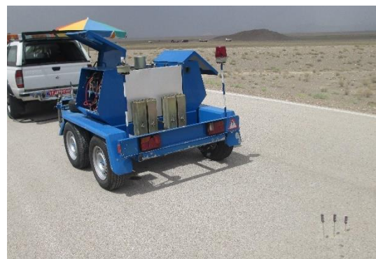
شکل ۲. آزمایش FWD همراه با اندازه‌گیری دمای عمق
