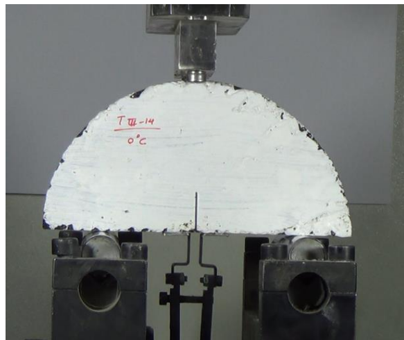
شکل ۴. جزئیات قرارگیری نمونه تحت آزمایش SCB
