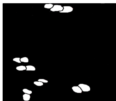
شکل ۸: جدا کردن سلول های هم پوشانی با استفاده از روش عملیات مورفولوژی پیشرفته
