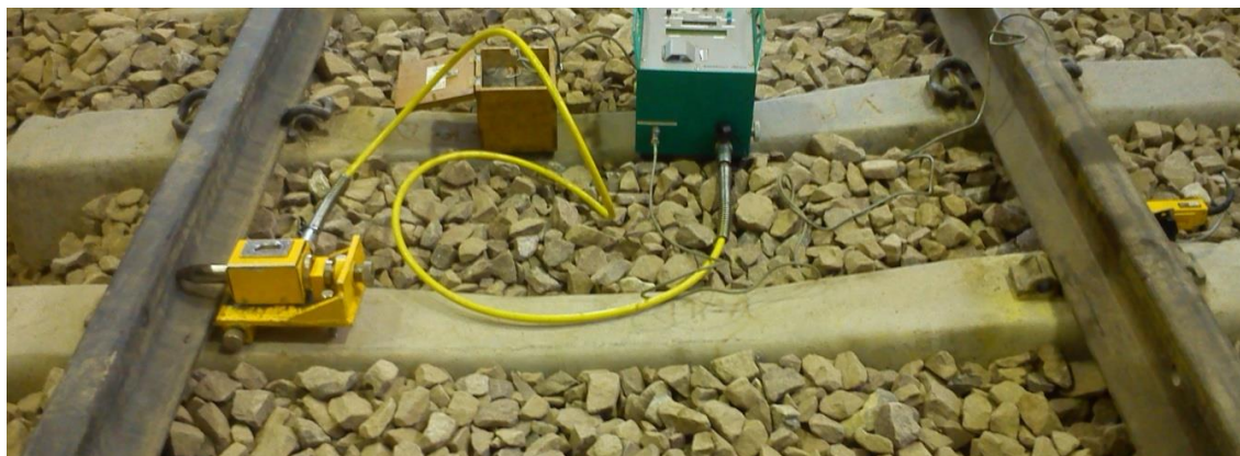
شکل ۱۱. ابزاربندی تراورس جهت انجام آزمایش استاتیک STPT
