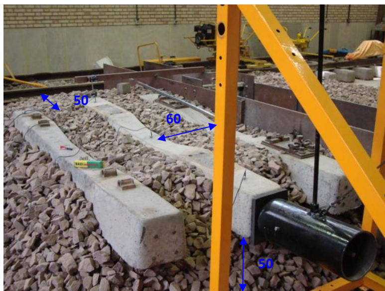
شکل ۲. ابعاد هندسی مقطع بالاستی آزمایش
