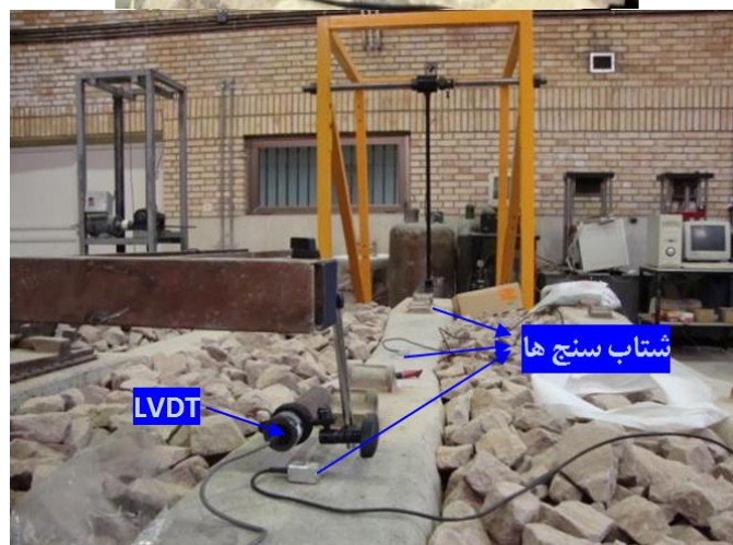
شکل ۳. محل نصب سه شتاب‌سنج و LVDT تراورس آزمایش
