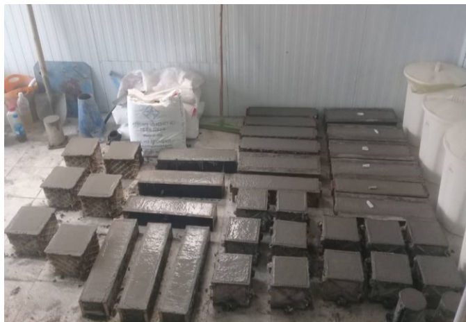
شکل ۶. نمونه های بتن باکتریایی در قالب های مکعبی و تیری شکل استاندارد
