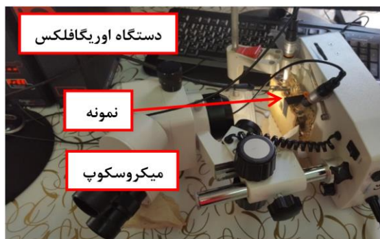
شکل ۳- چیدمان آزمایش مشاهده‌ی لحظه به لحظه‌ی حفره دار شدن و ترک خوردگی تحت تنش
