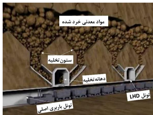
شکل ۲- شماتیک ساده شده یک معدن تخریب بلوکی
