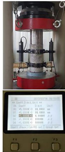
شکل ۵. چیدمان آزمایش مقاومت فشاری و مدول الاستیسیته
