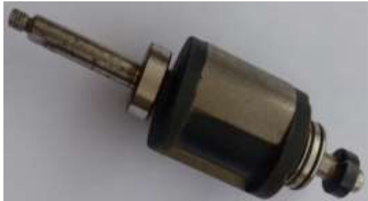
شکل ۹- روتور ساخته شده با فاصله هوایی غیریکنواخت
