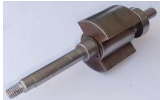
شکل ۷- روتور ساخته شده برای فاصله هوایی یکنواخت
