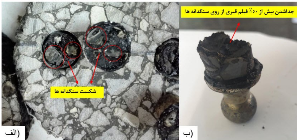
شکل ۱۱. الف) مکانیسم خرابی در پیوستگی در نمونه‌های خشک و ب) مکانیسم خرابی در چسبندگی در نمونه‌های مرطوب
