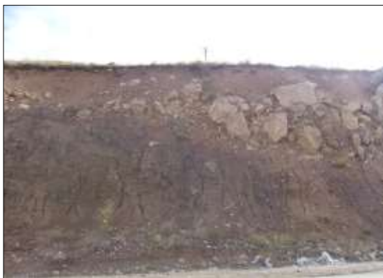
شکل ۵- توالی رسوبات لغزشی در دیواره ترانشه محل زمین- لغزش رسوبات دانه درشت کوهرفتی در بالا و رسوبات هوازده دانه ریز در زیر [۱۲].
