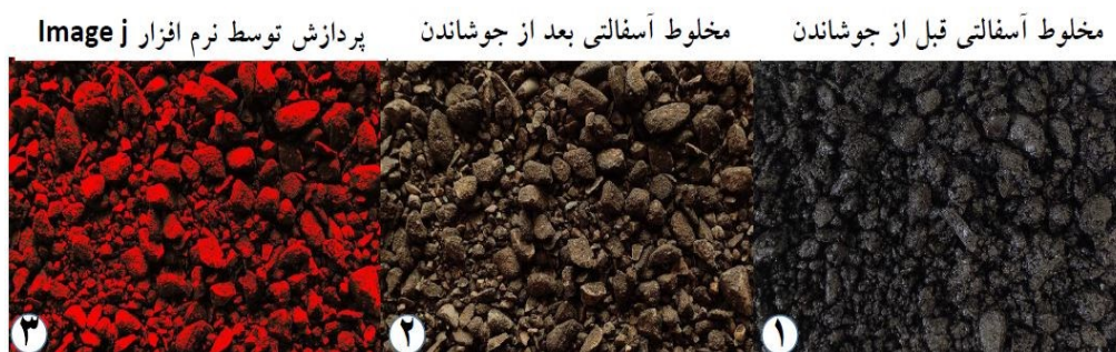
مراحل تعیین میزان عریان‌شدگی مخلوط آسفالتی در آزمایش آب جوشان توسط نرم‌افزار پردازش تصویر Image j
