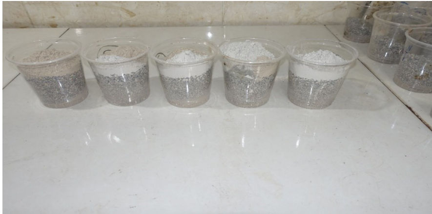
شکل ۳. پودر بتن بازیافتی ضایعات ساختمانی به‌عنوان فیلر با نسبت درصدهای مختلف در مخلوط‌های اصلاح شده
