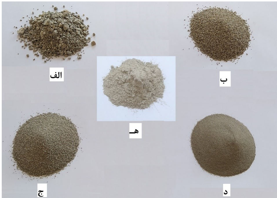
شکل ۱. مراحل تهیه پودر بتن بازیافتی ضایعات ساختمانی مورد استفاده در این پژوهش
