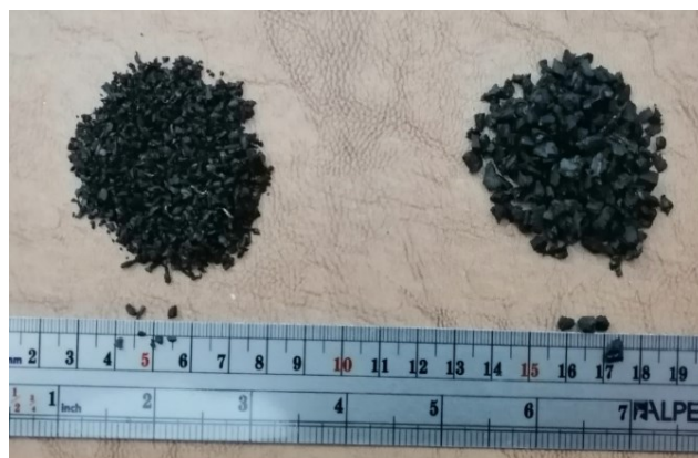
شکل ۲. خرده لاستیک استفاده‌شده در ستون‌های سنگی
