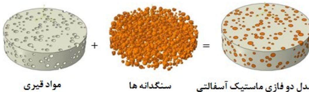
شکل ۳. تولید مدل دوفازی ماستیک آسفالتی با استفاده از عملگر بولی و Tie کردن در نرم افزار آباکوس برای شبیه سازی نمونه مورد استفاده در آزمایش جاروب فرکانس با استفاده از DSR
