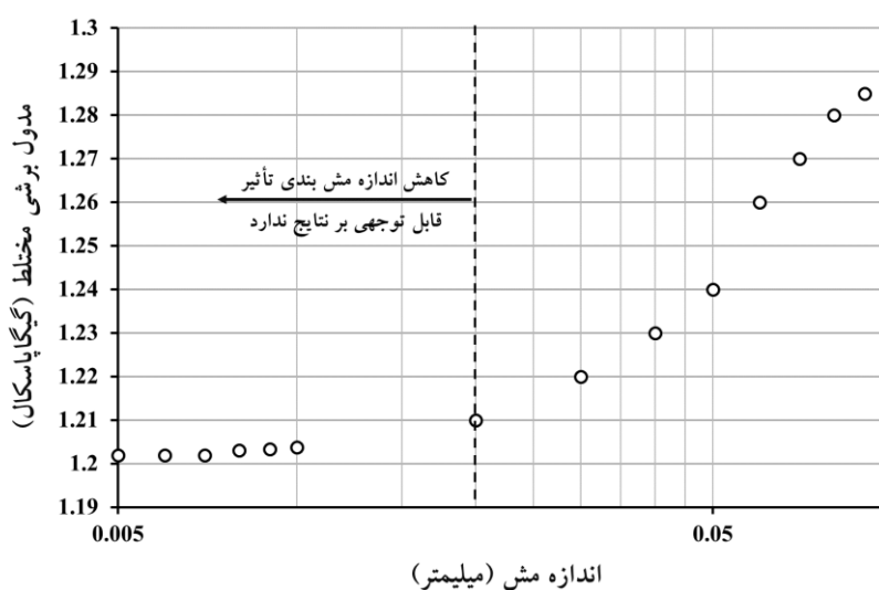
شکل ۸. تغییرات مقدار مدول برشی مختلط با اندازه مش مورد استفاده و بررسی همگرایی آن
