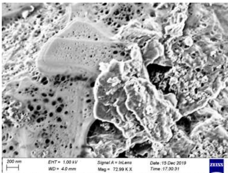
شکل ۳ تصویر FE-SEM نانوکامپوزیت Ag-RGO.
