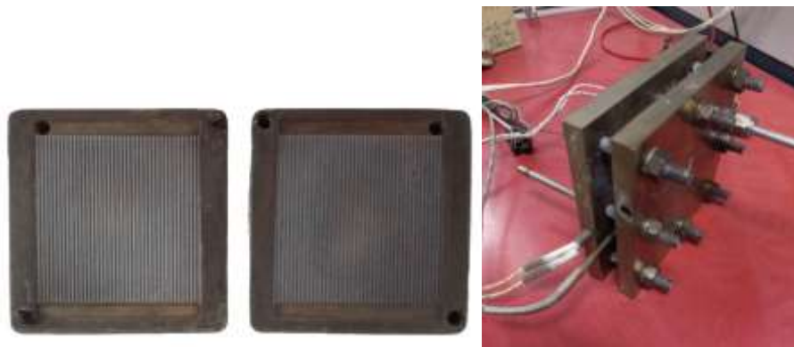
شکل ۱. راکتور میکروکانال با صفحات فکی، اتصالات، هیتر و ترموکوپل و صفحات میکروکانال
