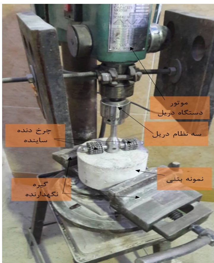
شکل ۳. دستگاه سایش مطابق با استاندارد (ASTM, 1999) ASTM C944
