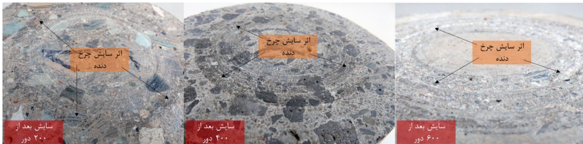
شکل ۱۰. سطح ساییده شده نمونه بتنی
