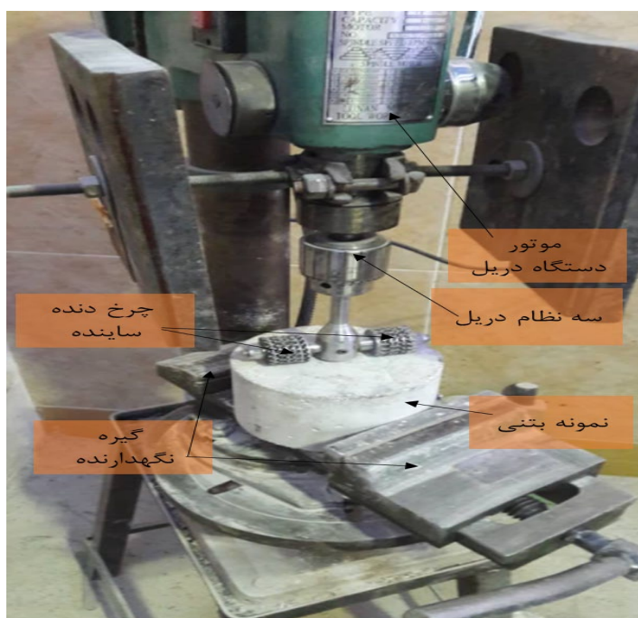
شکل ۳. دستگاه سایش مطابق با استاندارد (ASTM C944, ASTM, 1999)
