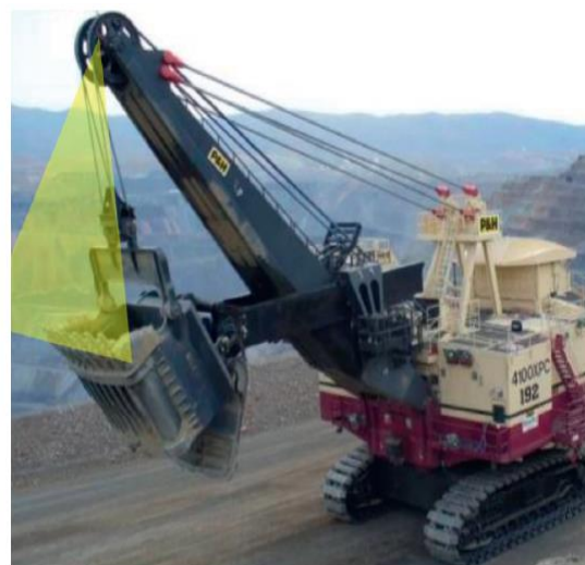
شکل ۵- سیستم پایش هوشمند دندان‌های باکت شاول
