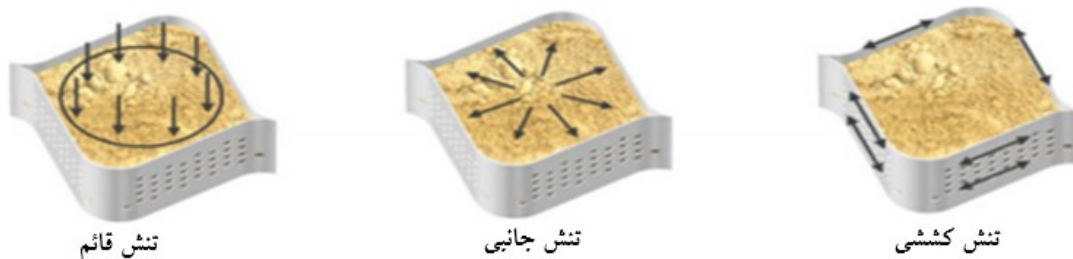
شکل ۷. مکانیزم رفتاری ژئوسل (سیتارام و همکاران، ۲۰۱۹)
