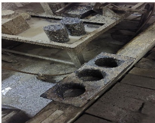
شکل ۲. نمونه پرس باکس و نمونه‌های مغزه‌گیری شده
