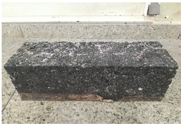
شکل ۲. نمونه پرس باکس و نمونه‌های مغزه‌گیری شده
