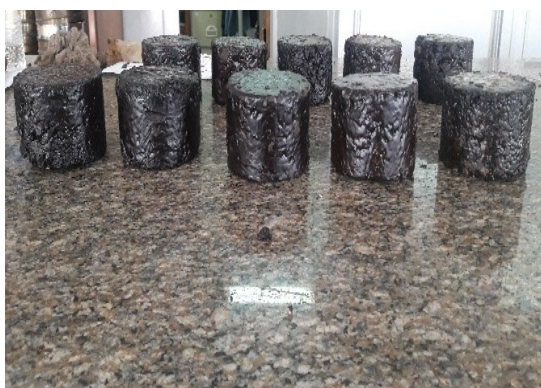
شکل ۳. نمونه‌های آسفالتی سرد بازیافتی، پوشیده شده توسط پارافیلیم (تصویر سمت راست) و پارافین (تصویر سمت چپ)
