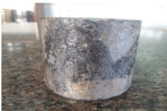
شکل ۳. نمونه‌های آسفالتی سرد بازیافتی، پوشیده شده توسط پارافیلیم (تصویر سمت راست) و پارافین (تصویر سمت چپ)
