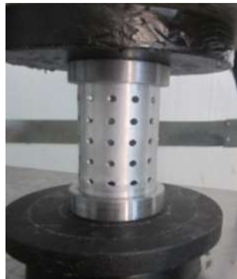
شکل ۳- لوله سوراخ‌دار بر روی فک پرس
