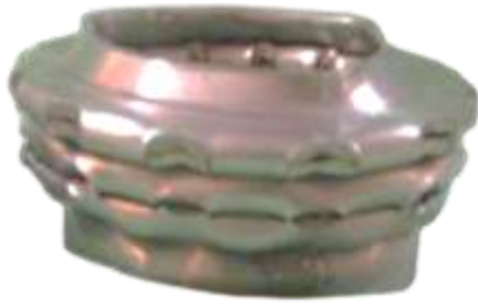
شکل ۵- لوله فولادی پس از لهیدگی
