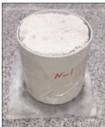
شکل ۳- قالب استوانه ای به جهت ریخته گری دوغاب.
