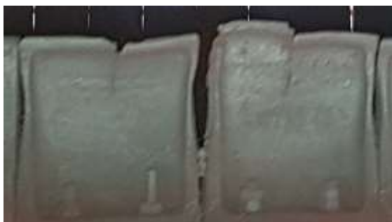
شکل ۲- اکسایش و ترک شدید (مطابق با بیشینه آسیب به سایدوال با درجه کیفی ۱؛ بدترین وضعیت).
