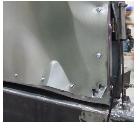
شکل ۷: خرابی اتصال ورق به قاب با پیچ خودکار تحت برش [۱۶]
