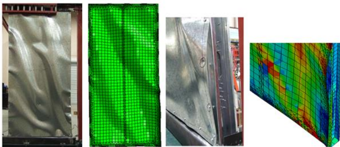
شکل ۱۲: مقایسه خرابی مدل اجزاء محدود و نمونه آزمایشگاهی [۱۶] برای دیوار ۴-۸-۴۳-۳۳-۶
