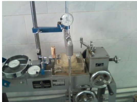
شکل ۳. نمونه داخل دستگاه برش مستقیم
