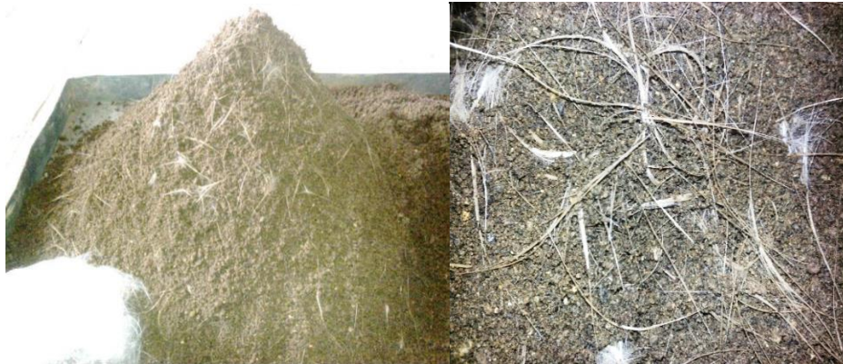
شکل ۲. مخلوط خاک و الیاف شیشه قبل (سمت راست) و بعد از مخلوط شدن (سمت چپ)
