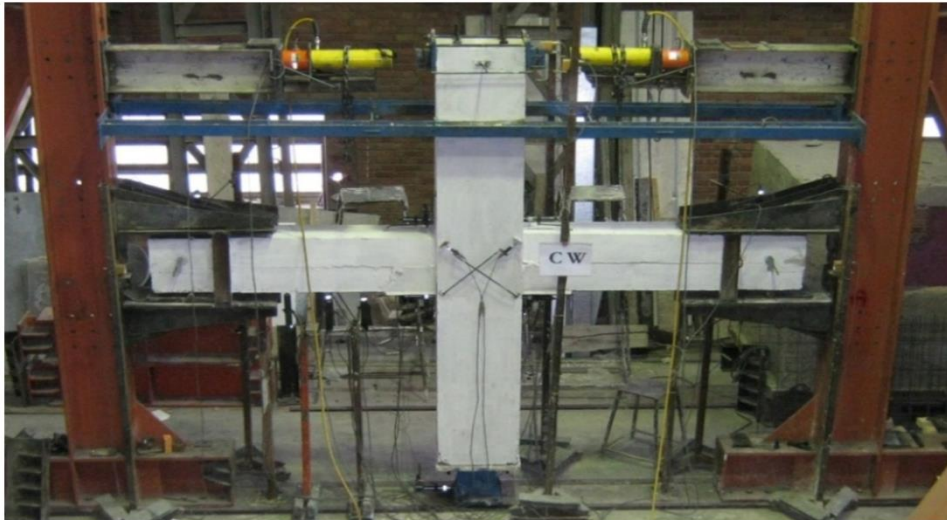
شکل ۱ - نمونه آزمایشگاهی اتصال مورد مطالعه [5]
