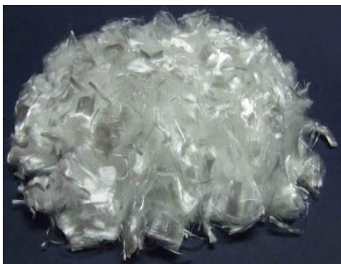
شکل ۲. الیاف پلی پروپیلن مورد استفاده (PP)
