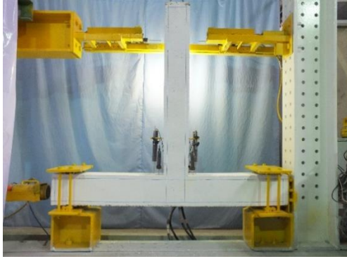
شکل ۵. نمونه اتصال بتنی ضعیف
