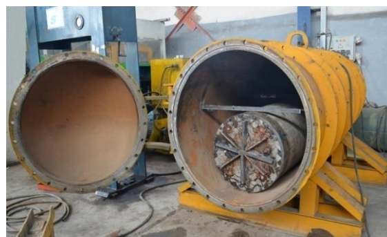
شکل ۵: مخزن آزمون فشار خارجی و نحوه‌ی مهار کردن بدنه‌ی کامپوزیتی
