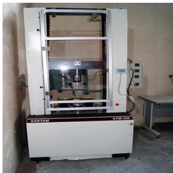
شکل ۴- دستگاه تست کشش مورد استفاده
