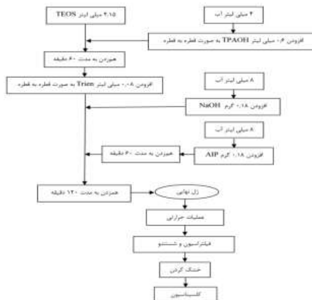
شکل ۱- مراحل سنتز زئولیت نانوساختار ZSM-5
