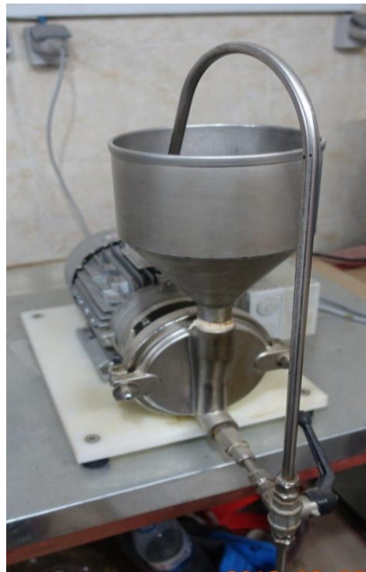
شکل ۲. دستگاه امولسیون‌ساز آزمایشگاهی شرکت عمارت گستر پیشگامان نوین
