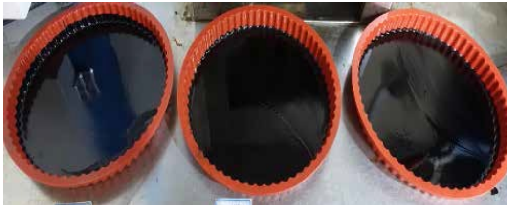
شکل ۴. قیر امولسیونی برای آزمایش تقطیر در دمای کم در ظروف سیلیکونی
