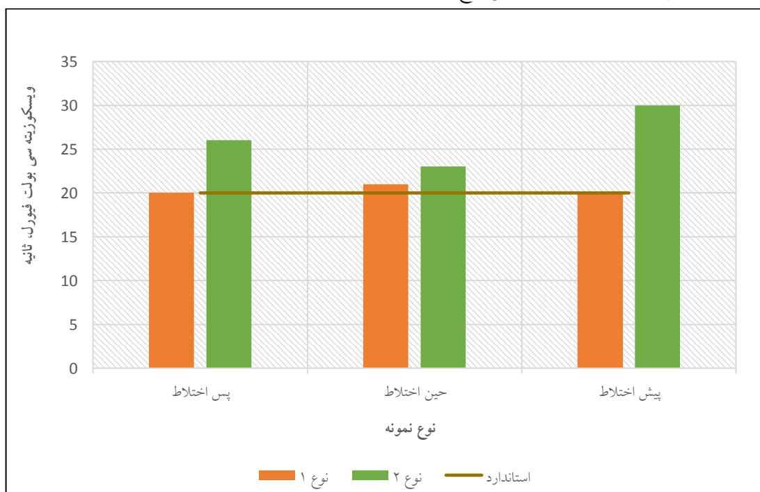
شکل ۵. نتایج ویسکوزیته سی بولت فیورل در ۲۵ درجه سلسیوس بر اساس استاندارد ASTM D2357
