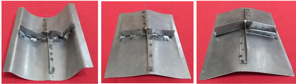
شکل ۱۴- فرم تغییرشکل ورق‌های با لچکی (الف) تخت، (ب) شعاع انحنا ۳۰۰ میلیمتر، (ج) شعاع انحنا ۱۱۰ میلیمتر.
