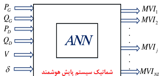
شکل ۴: ساختار مدل ارزیابی بهنگام آسیب‌پذیری خطوط مبتنی بر اندازه‌گیری و پایش هوشمند
