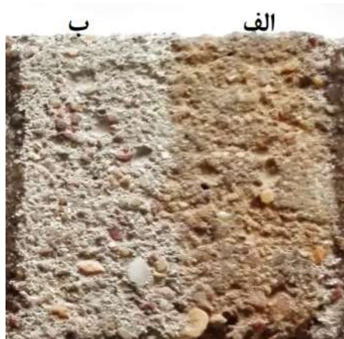
شکل ۱۰- تصویر نمونه بتن پس از قرار گیری در معرض آلودگی. (الف) قسمتی از نمونه که بدون پوشش بود (نمونه شاهد) (ب) قسمتی از نمونه که توسط محلول S3 پوشش داده شده
