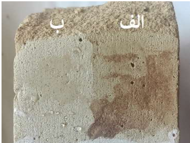
شکل ۱۱- تصویر نمونه آجر پس از قرار گیری در معرض آلودگی. (الف) قسمتی از نمونه که بدون پوشش بود (نمونه شاهد) (ب) قسمتی از نمونه که توسط محلول S3 پوشش داده شده
