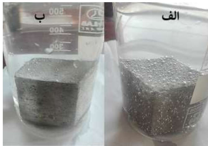
شکل ۸- تصویر آزمونههای بتنی غوطه‌ور در آب. (الف) آزمونه شاهد بدون پوشش (ب) آزمونه آبریز شده با نمونه S3
