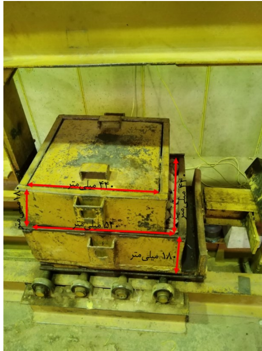
شکل ۴. نمای دستگاه آزمایش برش مستقیم بزرگ‌مقیاس
