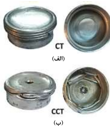
شکل ۴- فروریزش نمونه‌های درپوش‌دار استوانه‌ای (الف) لوله ساده، (ب) لوله حفره تحت شرایط مرزی یک‌سرگیردار
