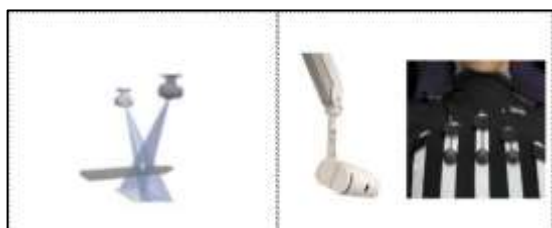
شکل ۱- سیستم تصویربرداری استریوسکوپیک اشعه ایکس (چپ) و دروبین حساس به نشانگرهای مادون قرمز خارجی روی جلیقه پوشیده شده توسط بیمار (راست)
