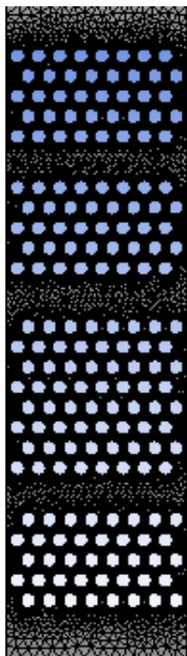
شکل ۶- نمایی از هندسه شبکه‌بندی شده محفظه جابجایی همراه با لوله‌های اضافه‌شده
