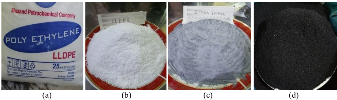
Fig. 4. Materials: (a),(b) LLDPE, (c) silica fume, and (d) waste rubber.
