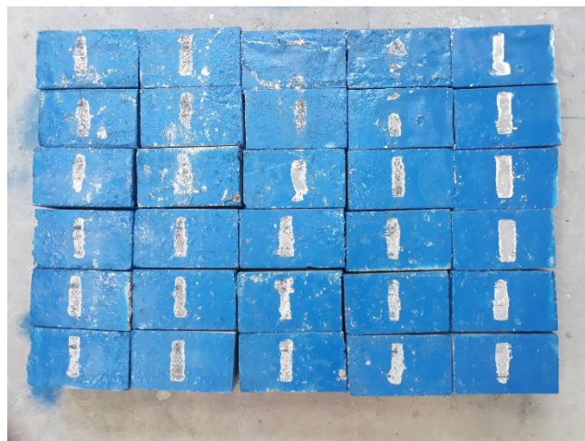
شکل ۹. نتیجه انجام آزمایش سایش چرخ پهن روی نمونه‌ها
