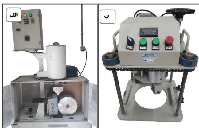
شکل ۵. دستگاه‌های سایش: الف) دستگاه سایش چرخ پهن و ب) دستگاه سایش چرخ ساینده
