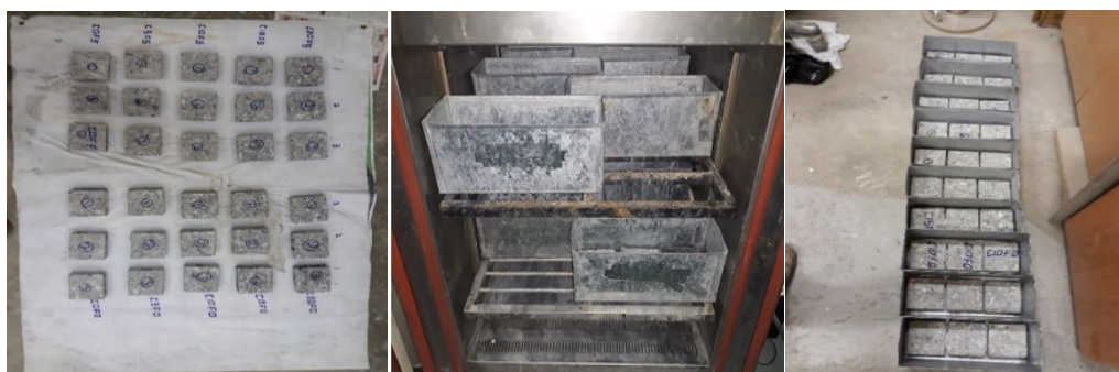
شکل ۶. آزمایش چرخه ذوب- یخبندان
