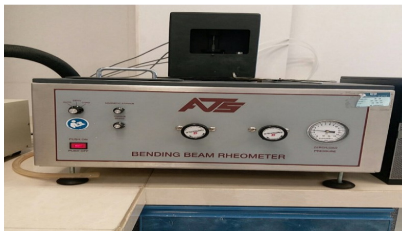
شکل ۲. دستگاه BBR مورد استفاده در این پژوهش
